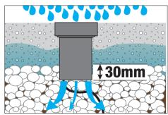
Al fine di permettere un adeguato drenaggio si consiglia di preparare un fondo di ghiaia in fase di installazione. Per il collegamento è necessario utilizzare connettori stagni.
